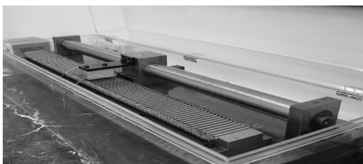
图3 场式直线时栅样机及实验装置
