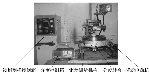
图8 改造完毕的全自动线切割机加工系统
