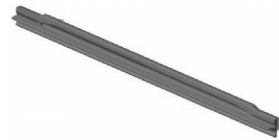
图 2 制动梁架锻件三维模型
